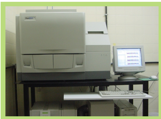
Sequenciador automático de DNA MegaBACE1000 com capacidade para realizar 96 reações de seqüenciamento em 100 minutos
